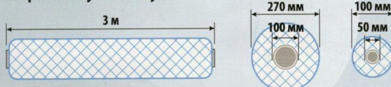
Блоки системы изготовлены секциями по 3 метра и доступны с диаметром внутренней трубы в 150 мм, 110 мм и 50мм.
