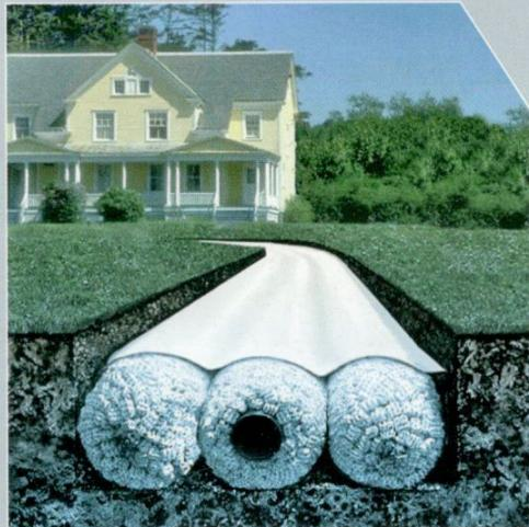
Новая дренажная система SoftRock состоит из гибкой перфорированной трубы, окружённой специально разработанным наполнителем из пенополистирола, который заключён в тканную геотекстильную сетку. Наш продукт сэкономит ваше время и сократит затраты на установку.
